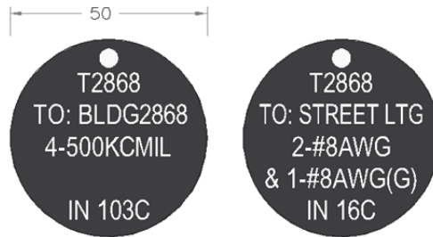
Figure-11 Conduit Identification Tags (Example)
